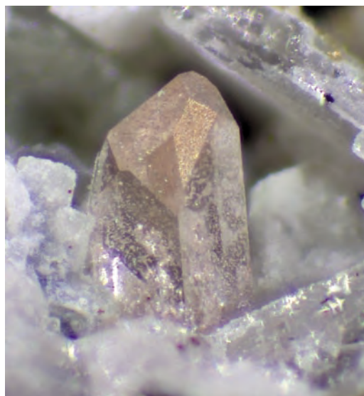
Fig. 19. Zircone di 0,8 mm; sono evidenti, in primo piano, le due faccette delle bipyramidi ditetragonali Fig. 17c); Case Collina Pitigliano, GR. Coll. e foto R. Pucci.
