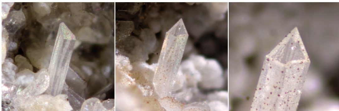
Fig. 30. Zirconi di 0,9 mm, Case Collina, Pitigliano (GR): nei geodini dello stesso incluso, cristallini di zircone molto allungati, tutti con una caratteristica terminazione "sbilenca" per un accrescimento sproporzionato della bipyramide; alcuni risultano cavi e le facce della bipyramide sono ridotte al solo contorno dello spessore di un paio di centesimi di millimetro (i puntini marroni sono idrossidi di ferro). Sulla sinistra un cristallo "normale", al centro un cristallo cavo e sulla destra il particolare della sua terminazione che mantiene le caratteristiche della bipyramide.
