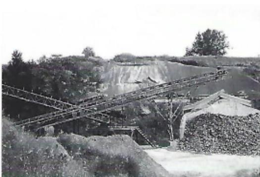
Foto 3: Alcune tramogge nella prima cava. È possibile notare come i materiali vengano accumulati in base alla pezzatura.
