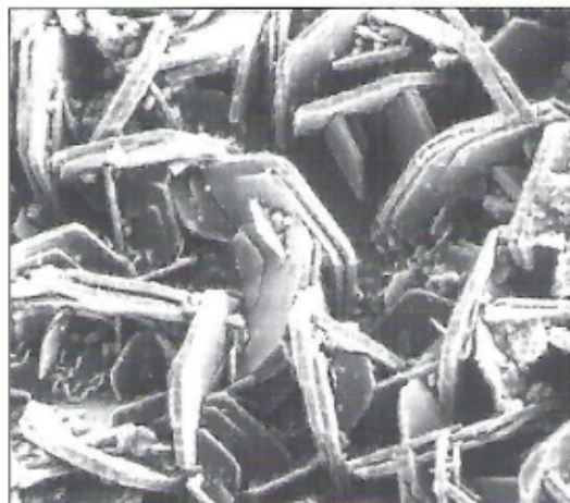
Fig. 3 - Aggregato di cristalli prismatici tabulari pseudoesagonali con spigoli arrotondati di calcofanite (triclino, classe pinacoidale). 500x ( 1 \text{ mm} = 3,6 \text{ }\mu\text{m} )
